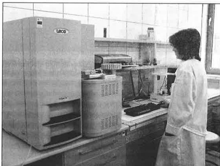
Fot. 4. Analizator elementarny TruSpec N (Leco)
